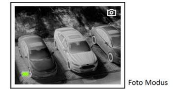
Nach einigen Sekunden wird die Bereitschaft des Modus durch ein Kamerasymbol im Display in der rechten oberen Ecke angezeigt. Durch erneutes kurzes Drücken der Taste kann ein Foto erstellt werden. Wird die Taste länger gedrückt, wird eine Videoaufnahme erstellt. Diese wird beendet durch erneutes längeres Drücken der Foto/Video Taste.
