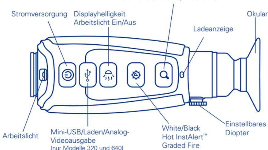
**Ein/Aus-Taste** – Die Scout III hat drei Energiezustände: Ein, Aus und automatische Abschaltung.
