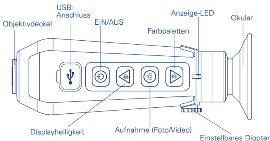
**Aufladen der SCOUT TK:** Schließen Sie das mitgelieferte USB-Kabel an ein Netzteil an. Beim Laden blinkt die LED. Im vollständig geladenen Zustand blinkt die LED grün.
