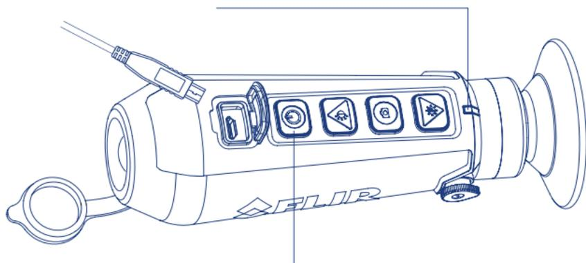
**Ein-/Ausschalten:** Zum Einschalten die EIN/AUS-Taste drücken. Im eingeschalteten Zustand leuchtet die LED. Im Okular wird zunächst das FLIR-Logo angezeigt, dann das Live-Bild. Zum Ausschalten die EIN/AUS-Taste gedrückt halten. Die Kamera wird nach einer Sekunde abgeschaltet.
